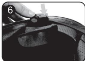
6. Con il lato del pin rivolto verso il basso e il foro di ricarica a sinistra, inserire l'unità principale nella scatola dell'unità principale.
